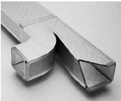
I canali di mandata e ripresa aria saranno realizzati con pannelli sandwich costituiti da un componente isolante in poliuretano espanso rigido di spessore 20 mm rivestito su entrambi i lati con lamine di alluminio. Anche la presa aria esterna e l'espulsione saranno realizzate con canale a pannelli sandwich.
