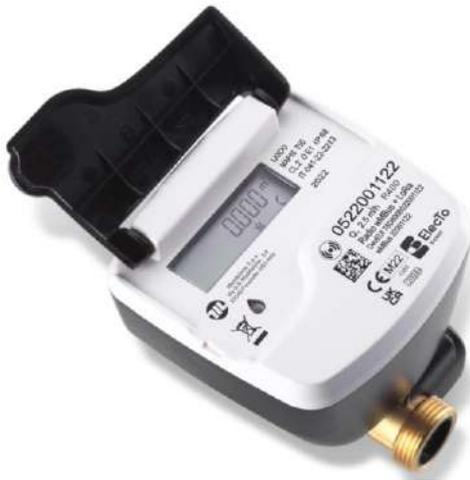
Sulla linea acqua fredda e acqua calda di ciascuna zona (servizi piano terra, piano primo, foresteria e cucina) verrà installato un contatore elettronico ad ultrasuoni, completo di display, radio integrata wM-Bus, OMS e/o LoRaWAN, batteria al litio, rilevazione anomalie, grado di protezione IP68.
